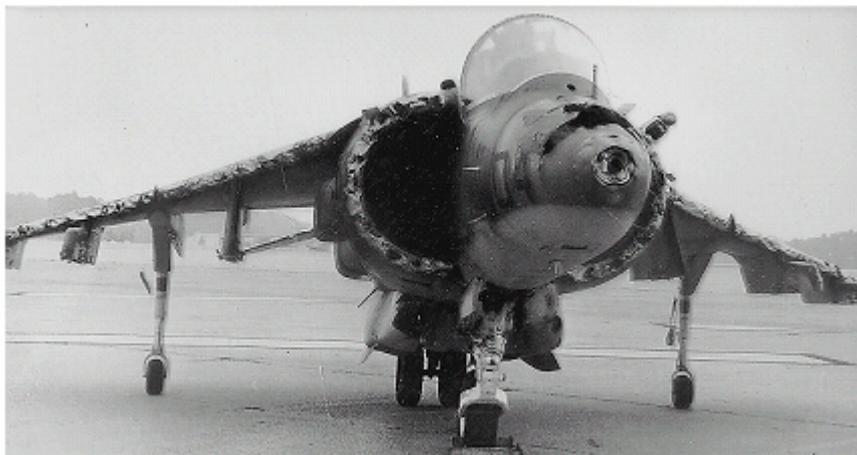
Рис. 33 Военный самолет после попадания в град
