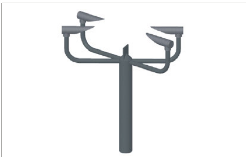
Рисунок 8-3. Измеритель прямого рассеяния с четырьмя головками
