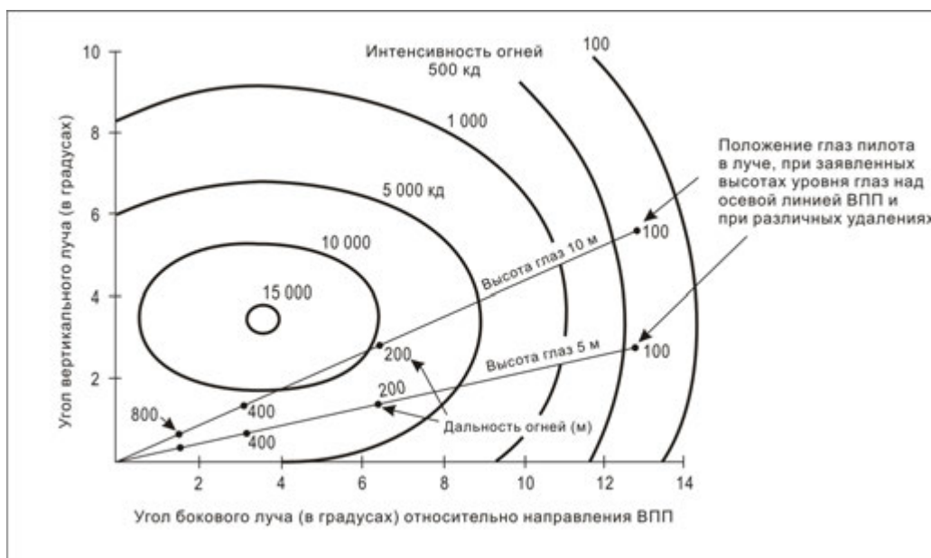
Рисунок 6-2. Диаграмма изокандел для бокового огня ВПП (новый огонь при максимальном режиме интенсивности) с указанием положения глаз пилота в луче при различных удалениях и высотах уровня глаз над осевой линией ВПП
