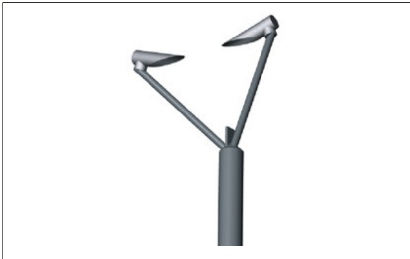
Рисунок 8-2. Направленный вниз измеритель прямого рассеяния
